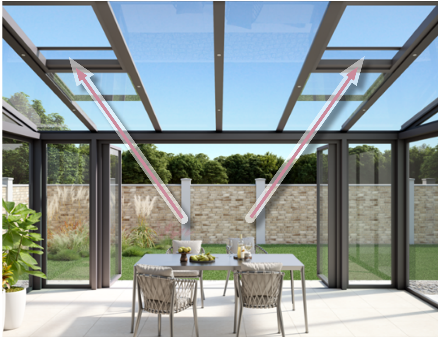
Der Kamineffekt auf einem Blick
